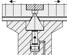
Para alcanzar la precisión necesaria de sincronismo, se fabrican todas las partes con alta precisión. Las mandíbulas de base nitruradas tienen 3 roscados para la fijación. En función del diámetro deseado de centraje, pueden fijarse las mandíbulas de sujeción adaptadas por lo menos siempre con 2 tornillos.
